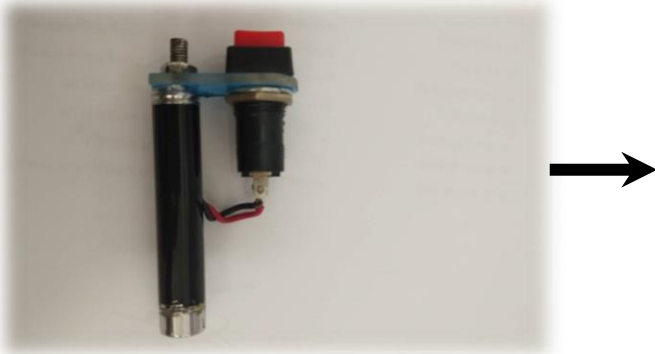
รูปที่ 12 ประกอบเข้ากับแผ่นพลาสติกแข็งยึดด้วยน็อตตัวเมีย
